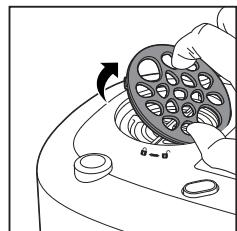
2 Промойте фильтр под проточной водой.
