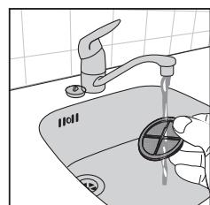
3 Дайте фильтру полностью высохнуть. Поместите его в основание прибора и закройте крышку фильтра.
