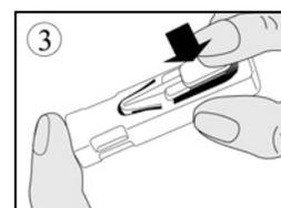
7. Hrot jehly se po píchnutí automaticky a bezpečně vtáhne zpět.
