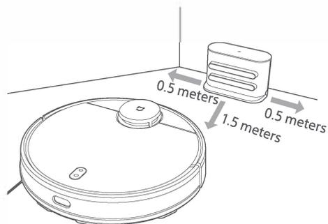
4. Pokud přístroj používáte poprvé, stiskněte a držte tlačítko (⏻) po dobu 3 vteřin, abyste přístroj zapnuli. Jakkmile se ukazatel rozsvítí, umístěte přístroj ručně na nabíjecí stanici, aby se nabíjel. Při úklidu pak stačí jen stisknout tlačítko (🏠) a přístroj se automaticky sám vrátí do nabíjecí stanice, aby se dobil.
