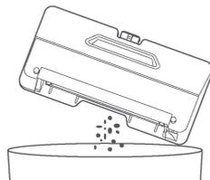
2. Vyprázdňte obsah nádoby na prach. Vyčistěte nádobku pomocí přiloženého čistícího štětce, poté vložte zpět filtr.
