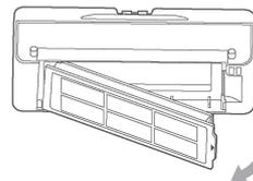
1. Otevřete víko přístroje, vyjměte 2v1 nádobku na prach se zásobníkem vody a vyjměte filtr, jak je znázorněno na obrázku.
