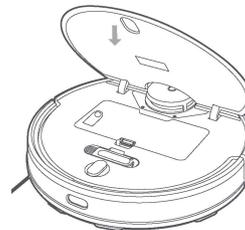
3. Vložte 2v1 nádobku na prach se zásobníkem na vodu zpět do přístroje, dokud nezapadne na místo. Pak zavřete víko přístroje.
