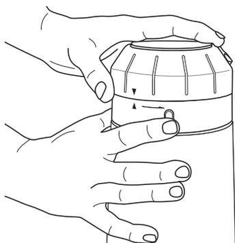
4. Stále držte tlačidlo UNLOCK stlačené a druhou rukou zdvihnete horný mlecí kameň za rukoväť a vyberte ho smerom hore – pozrite obrázok nižšie. Uvoľnite tlačidlo.
